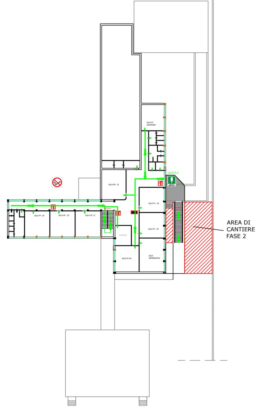
Planimetria cantiere fase 2 - Percorsi di esodo
